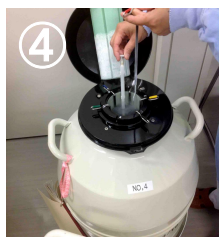
④ 液体窒素蒸気下に5分静置。その後、完全に凍結する。
